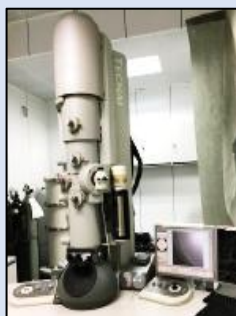
FEI Tecnai G 2 200 kV cryo-TEM
